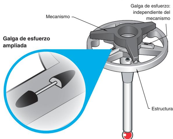
Puesto que la detección es totalmente independiente del mecanismo de la sonda, las sondas Rengage disponen de unas características que no se obtienen normalmente con sondas de diseño convencional.
