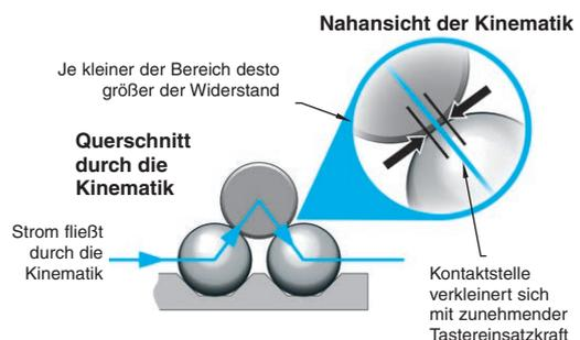
Wiederholgenaue elektrische Auslösungen und das mechanische Rücksetzen des Mechanismus sind bei diesem Vorgang entscheidend und Grundvoraussetzung für eine zuverlässige Messtechnik.
