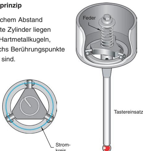
Unter Federbelastung entstehen Kontaktstellen zwischen den Kugeln und den Zylindern, durch die elektrischer Strom fließt. Bei der Berührung (Antastung) eines Werkstücks bewegt die über den Tastereinsatz übertragene Kraft die Kugeln und Zylinder auseinander, sodass sich die Kontaktstellen verkleinern und ihr elektrischer Widerstand zunimmt.
