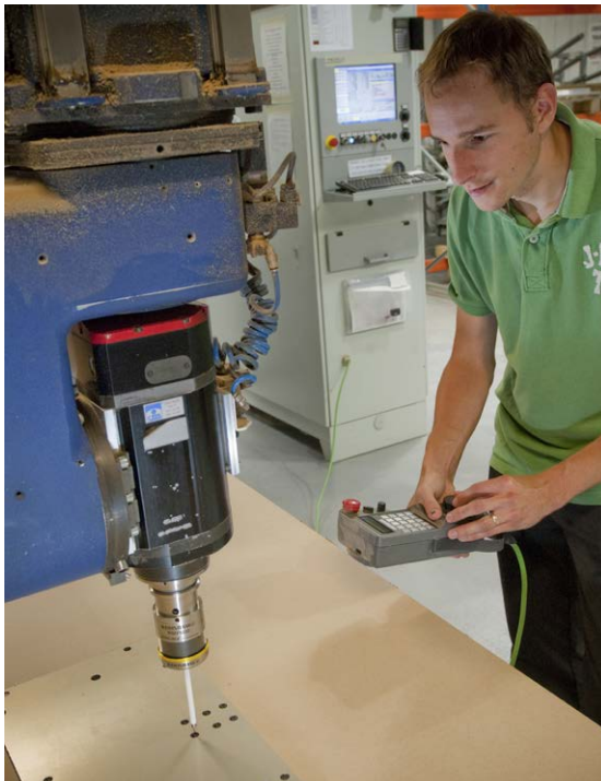
Die mit einem RMP600 Messtaster ausgestattete 5-Achsen-Fräsmaschine von CMS wird zur Bearbeitung von AW159 Komponenten und anderen Werkzeugen Betriebsintern verwendet
