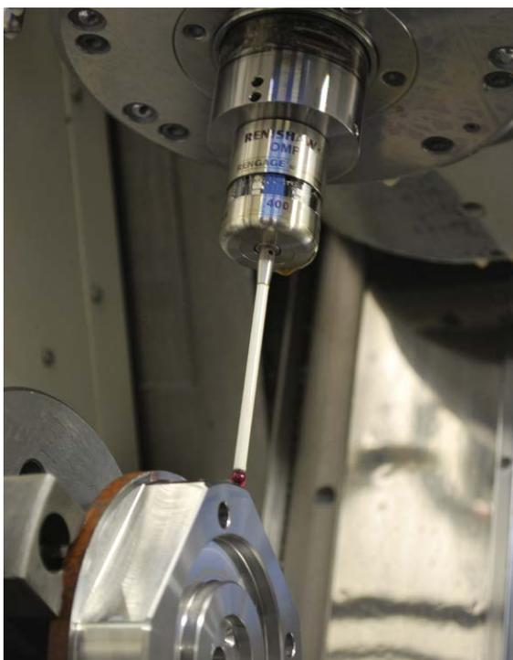
Integrex Mehrachsen-Fräs-/Drehmaschine von Mazak mit einem OMP400 von Renishaw in der Spindel
