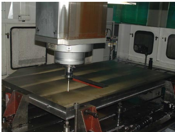
Renishaw的RMP60无线电工件检测测头用于检测亚华印机加工件
