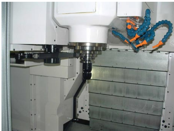
Renishaw的MP7在立式加工中心上的应用
