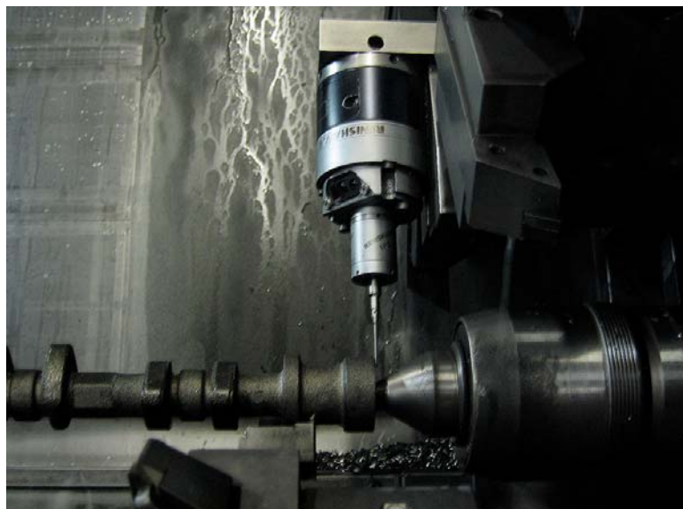
Le système de palpé Renishaw LTO2S monté sur un tour CN à tourelles jumelées permet de placer précisément la face avant l'usinage, l'ensemble du cycle ne prenant que 90 secondes
