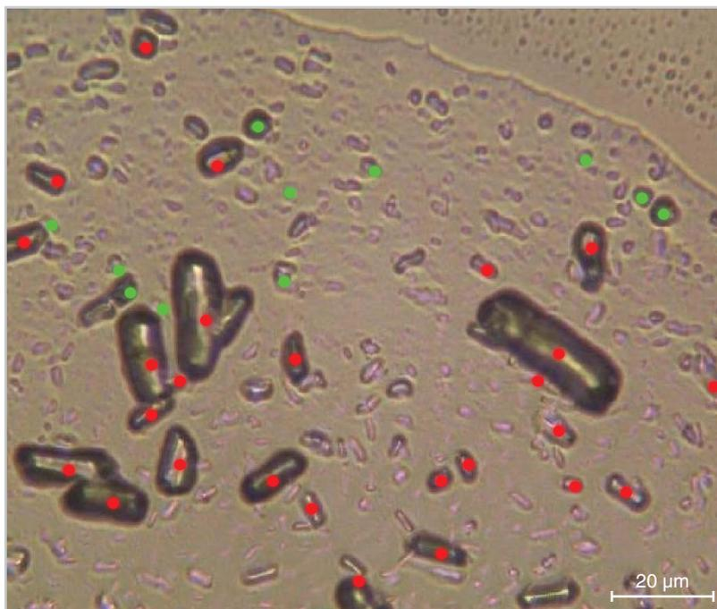
ポイント測定によるマッピング：スプレー式点鼻薬の滴に含まれる単一粒子にターゲットを絞って高速分析。このイメージには、薬剤と賦形剤の分布が光学像に対して相対的に示されています。
