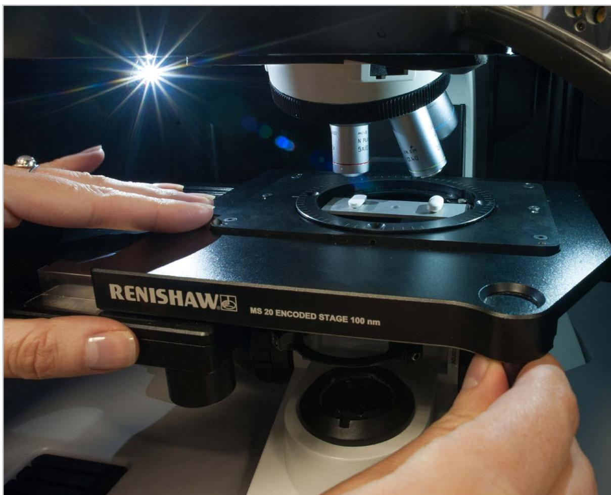
レニショー特許のモーター駆動式ステージは、手動での移動中も、エンコーダを使用して位置のトラッキングを行います。
