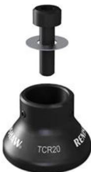
2. Installer la patte du TCR20 dans la base et orientez le rack. Bloquez le rack à l'orientation correcte en serrant les trois vis sans tête qui se trouvent dans la base du rack.
