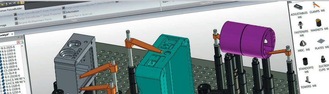
FixtureBuilder es un paquete de software 3D diseñado para crear configuraciones y documentación de fijaciones de pieza. También puede utilizarse para facilitar la programación offline, sin conexión a la máquina.
