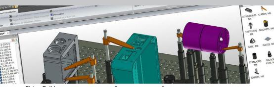
FixtureBuilder – это программное обеспечение для трёхмерного моделирования, предназначенное для создания сборок из крепёжных приспособлений и документации к ним. Также он может использоваться при автономном
