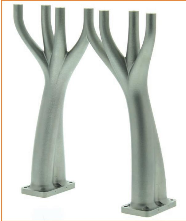
La produzione additiva in metallo è un processo che consente di partire da un modello CAD e creare un oggetto 3D sovrapponendo, uno dopo l'altro, sottili strati di polvere di metallo.
