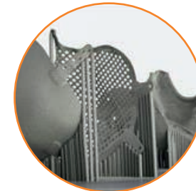
Entfernen von Stützen
