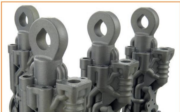
Cette technologie de fabrication additive métallique permet la production de géométries extrêmement complexes car elle n'est pas contrainte par les mêmes règles que celles associées à l'usinage soustractif et aux autres techniques traditionnelles de fabrication.
