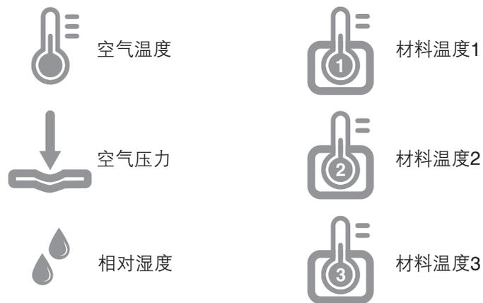
在传感器侧面上也标有空气和材料温度传感器图符。
