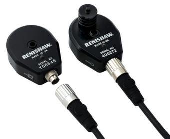
所示的空气温度和材料温度传感器为单独配件，与通信电缆一起提供。每条电缆有一个母螺纹连接头可与传感器连接，并有一个公螺纹连接头可与XC补偿器侧面的相应插槽连接。
