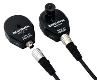
空氣溫度和材料溫度感測器為單獨的配件，並與通訊連接線一起提供。每條連接線具有母螺紋連接頭可以與感測器連接，並具有公螺紋連接頭可以與 XC 補償器側面的相應插口連接。
