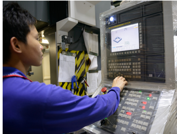
操作員以 Renishaw GUI 和 RMP60 測頭量測模座孔位尺寸
