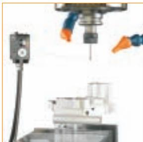
Sistema TRS1 di riconoscimento utensili a singola unità
