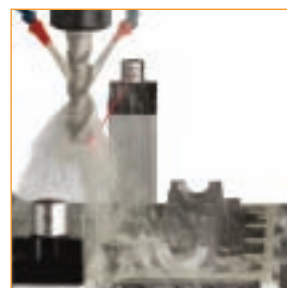
Vysokorychlostní bezkontaktní laserové zařízení NC4 k dispozici ve fixním nebo odděleném provedení
