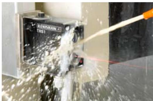
Este proceso de detección hace posible la rápida inspección de cada herramienta al principio o al final del ciclo.
