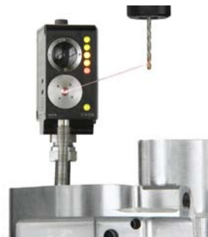
El TRS1 puede montarse en cualquier superficie rígida de la máquina, puesto que la posición relativa del dispositivo con respecto a la herramienta no es crítica. El ajuste es simple y rápido, puesto que no requiere un alineamiento preciso con los ejes de la máquina.
