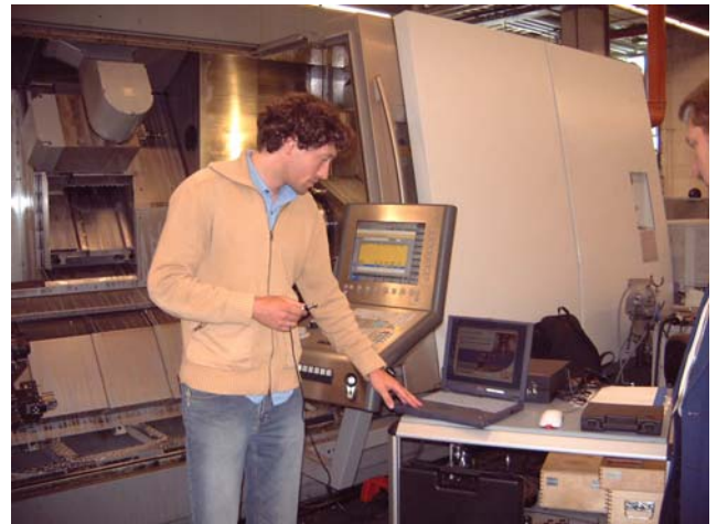
Bild 1: Fehler und Tendenzen erkennen: Jürgen Aumer, Leiter Instandhaltung beim Werkzeughersteller KOMET, misst in regelmäßigen Intervallen die Genauigkeiten sämtlicher Bearbeitungszentren mit dem Kreisformtest
