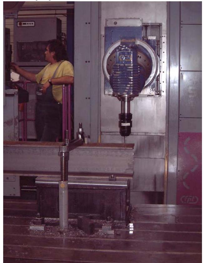
Bild 1. Schneller durch Tasten: Funk-Meßtaster minimieren die Rüstzeiten beim Fertigen großer Werkstücke durch Erfassen von Daten zur Nullpunkt-Korrektur
