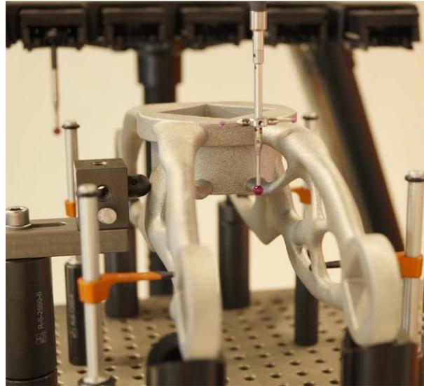
圖 3：Renishaw Equator™ 檢具系統正在測量 Bleu 汽車鉸鏈組件
