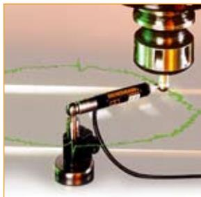
Ballbar QC10 – test rapido per verificare le prestazioni delle macchine utensili
