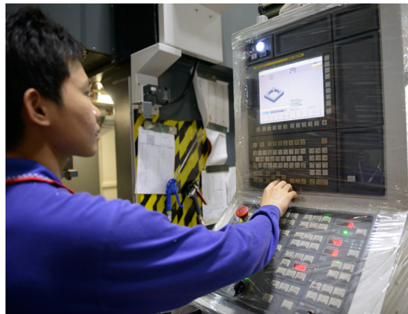
操作员使用雷尼绍GUI和RMP60测头测量模座孔位尺寸
