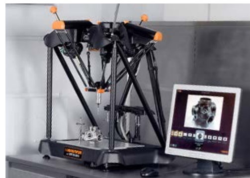
System komparatora charakterystyk geometrycznych Equator™
