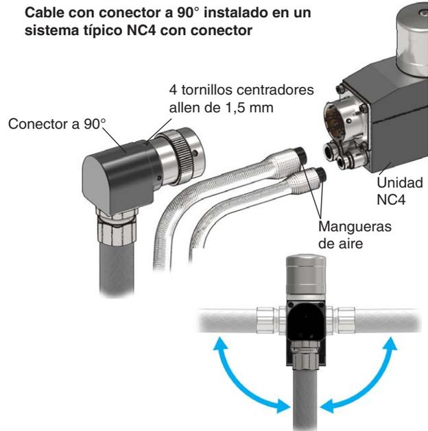
Afloje los 4 tornillos centradores para ajustar la orientación. Apriete entre 0,6 Nm y 0,7 Nm
