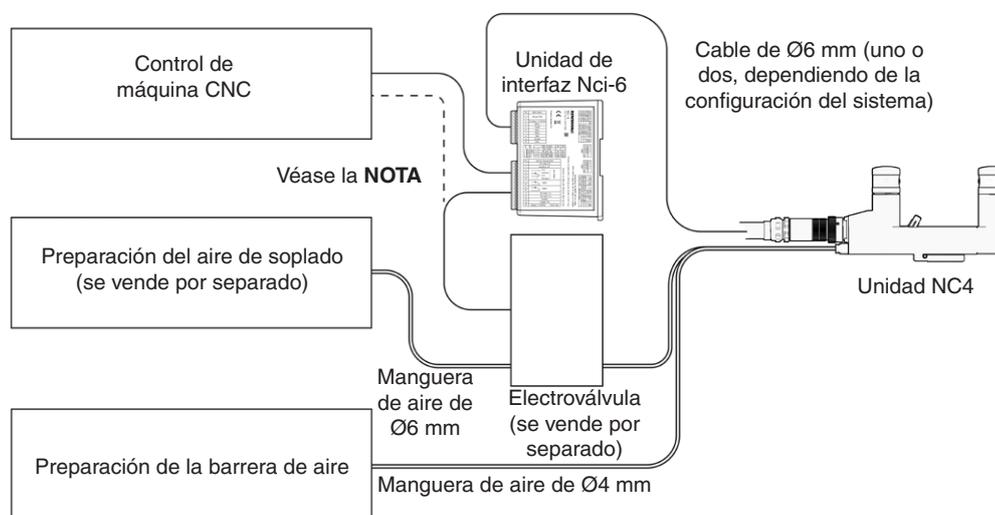
**NOTA:** La electroválvula puede controlarse mediante código M a través del relé auxiliar de la interfaz Nci-6, pines de CN2 3, 4, 5 y 6. También puede conectar el código M directamente a la electroválvula.
