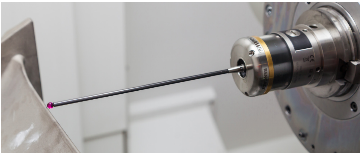
Mjerna glava RMP600 na alatnom stroju locira položaj aerodinamičkog profila.
