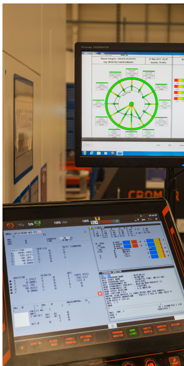
Ekran NC-Checker za mesečno poređenje
