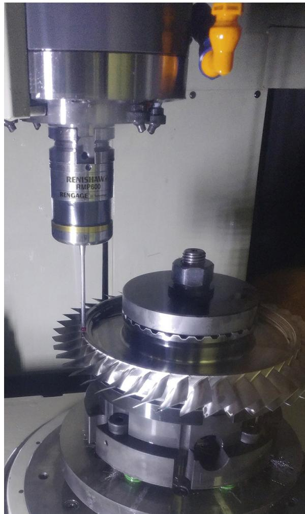
Visokoprecizna merna glava sa okidanjem na dodir Renishaw RMP600
