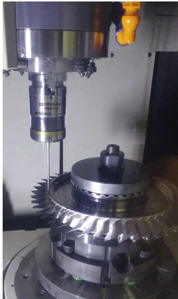
Visokoprecizna kontaktna mjerna glava RMP600 tvrtke Renishaw
