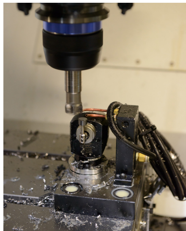
Mjerna glava za podešavanje alata RTS
