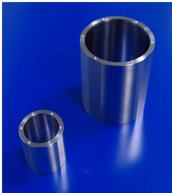
Merni cilindri za svetsku svemirsku misiju MICROSCOPE izrađeni su sa preciznošću 1 \mu\text{m} .
