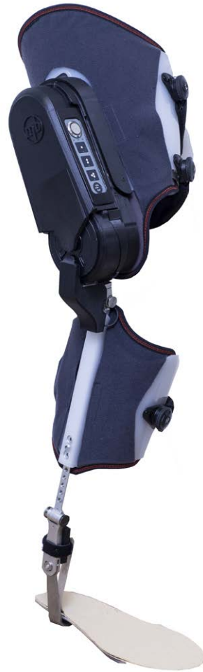
Marsi Bionics의 성인용 MAK(MB-Active Knee) 단일 관절 외골격
