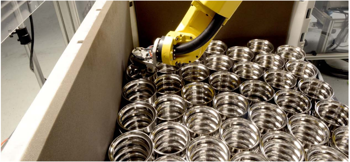
자동화된 FANUC 로봇이 부품을 상자에 넣고 팔레트로 운반합니다
