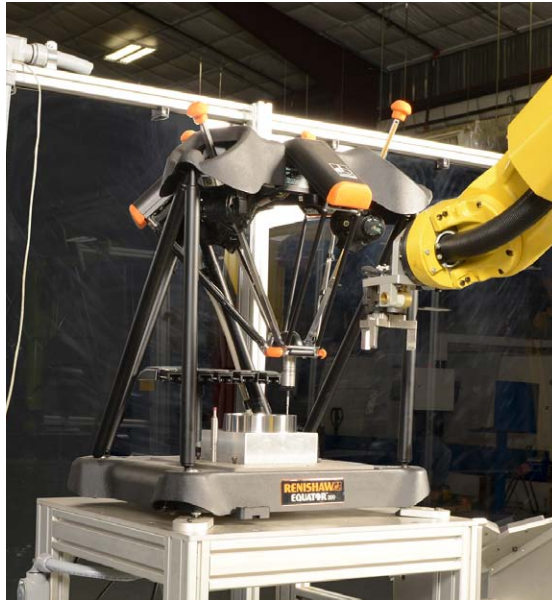
FANUC 로봇은 자동화된 셀에서 Equator를 로드합니다
