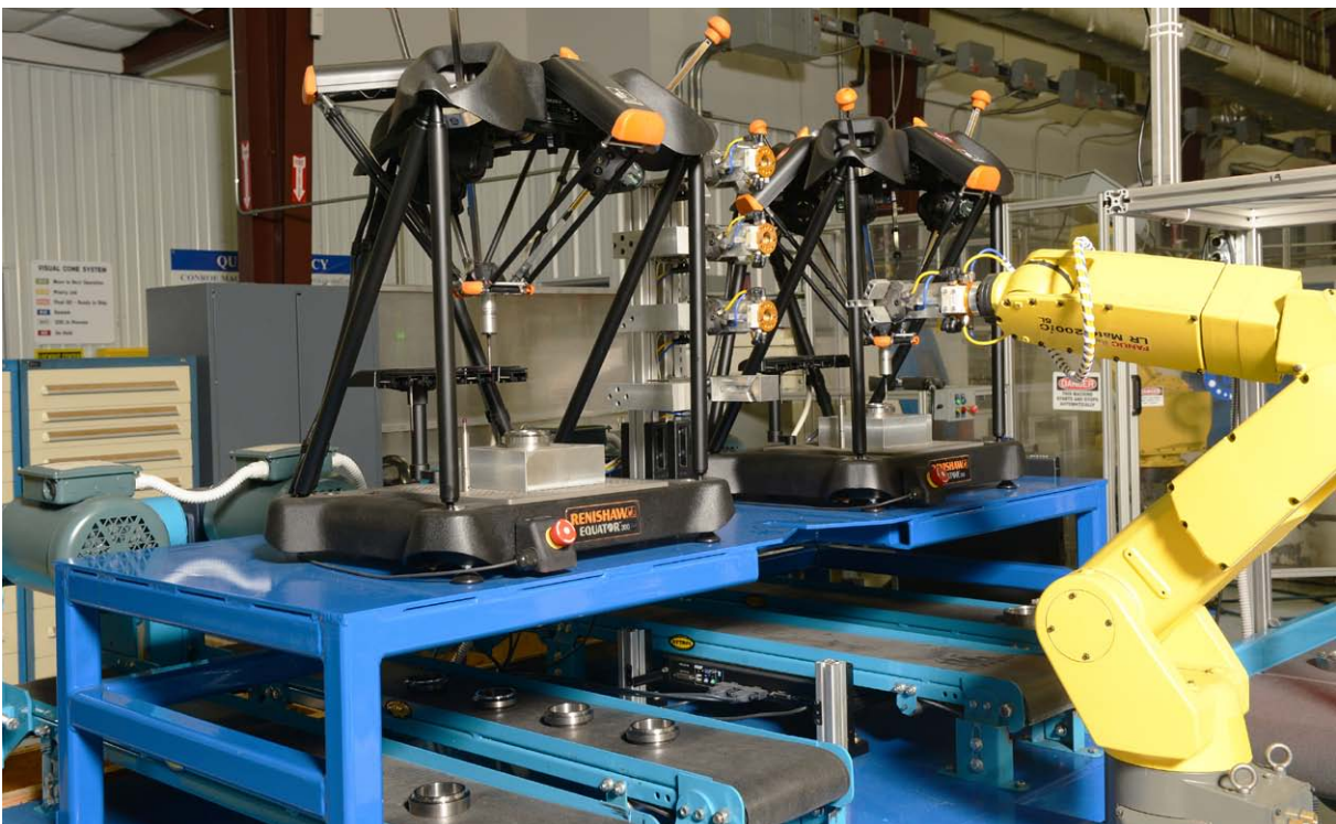
개발 중 - Conroe의 새 듀얼 Equator 자동화 셀
