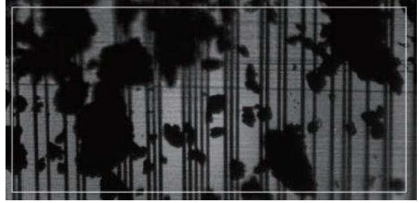
图1：清洁栅尺的图像，以及颗粒污染覆盖栅尺的很大一部分区域，但仍可确定相位信息的栅尺的图像。
