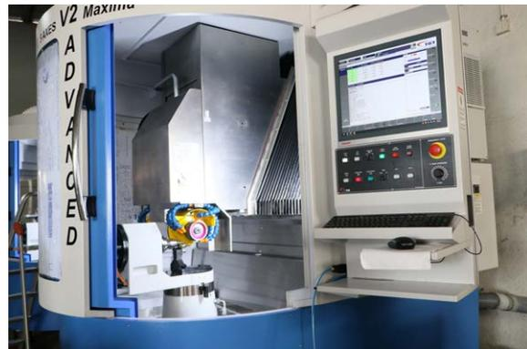
Rectificadora de herramientas V2 ADVANCED Maxima de TGT
