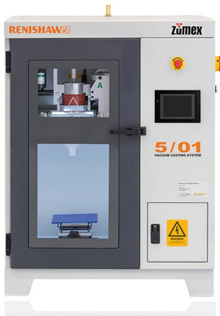
Máquina de colado por vacío 5/01 PLC de Renishaw
