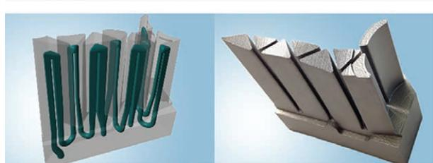
Canales de refrigeración justo debajo de la superficie de moldeo para reducir la duración del ciclo de prensado
