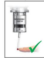
**PRECAUCIÓN:** No retire las baterías mientras esté en el modo de configuración. Para salir, deje el palpador sin tocar durante más de 20 segundos.
