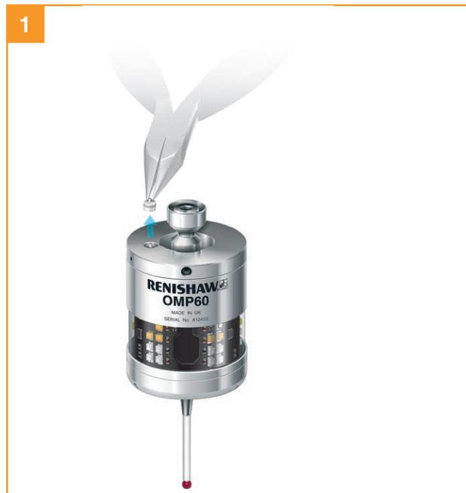
**NOTA:** En situaciones en las que se va a utilizar la sonda OMP60 con interruptor en el cono, es necesario retirar el tapón de la parte trasera de la sonda con unos alicates. Éste debe sustituirse por la bobina (A-4038-0303).
