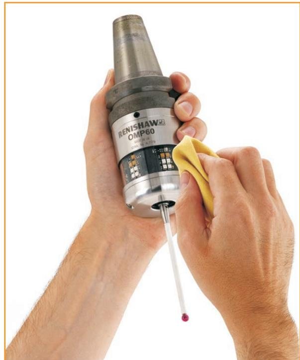
**⚠ PRECAUCIÓN:** La sonda tiene una ventana de cristal. Si se rompe, manéjelo con cuidado para evitar lesiones
