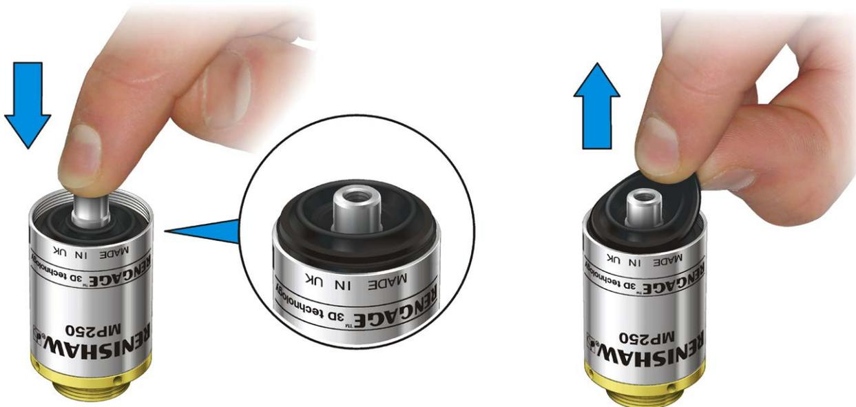
2. Rosque la herramienta de colocación del diafragma (n.º de referencia Renishaw A-5500-1652) incluida en el kit de sustitución del diafragma en el soporte del palpador.
