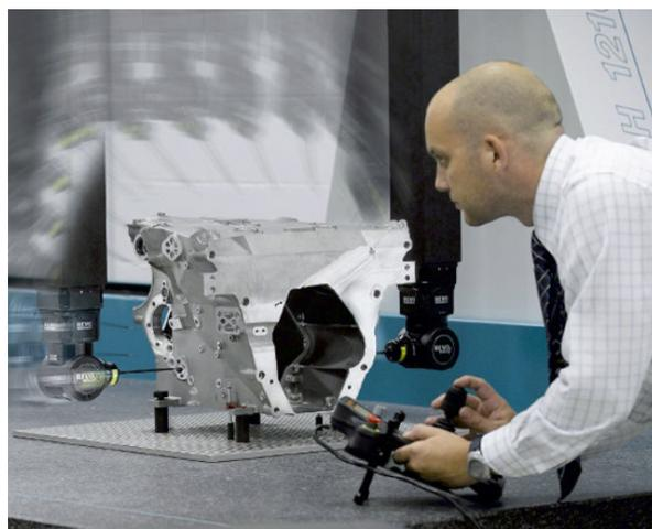
*La exploración de 5 ejes permite una inspección rápida y perfecta de componentes complejos, sin pausas para indexado y cambio de palpadores.*
