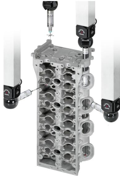
*Los cabezales de indexado y los sensores modulares flexibles aumentan la flexibilidad de medición y automatización, facilitando el acceso a todos los elementos de la pieza a medir.*
