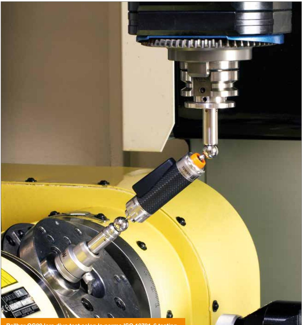
Ballbar QC20 lors d'un test selon la norme ISO 10791-6 testing
