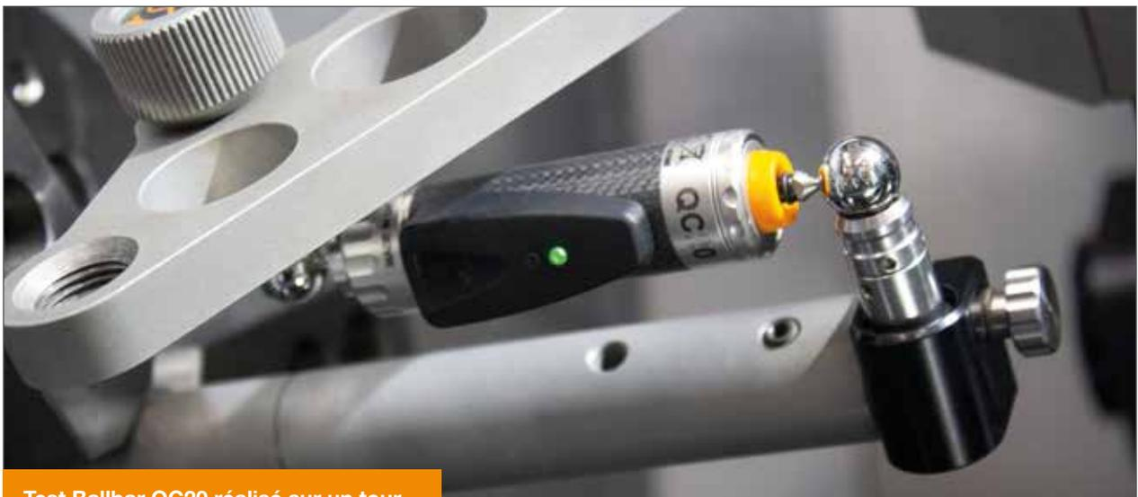
Test Ballbar QC20 réalisé sur un tour
