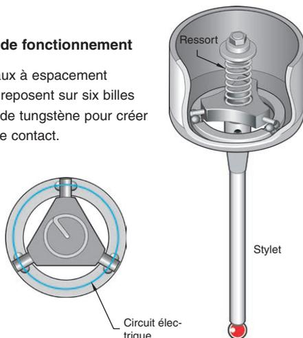
La force du ressort crée des zones de contact, entre les billes et les rouleaux, au travers desquelles passe le courant électrique. Lorsqu'il y a contact (physique) avec une pièce, la force appliquée par le stylet éloigne les billes des rouleaux, réduit la taille des zones de contact et augmente leur résistance électrique.
