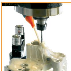
**Systèmes de réglage d'outil** – Réglage dynamique des outils d'usinage sur machines-outils.
