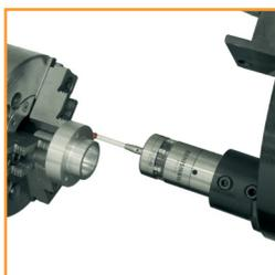
**Palpeurs de contrôle de pièces** – Mesures automatisées de position et d'alignement de composants.
