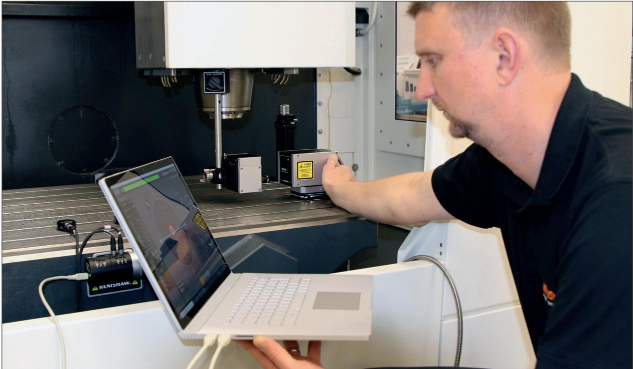
**Le Multi Axis Calibrator XM-60 offre aux utilisateurs des capacités de diagnostics machine puissantes grâce à la mesure de tous les degrés de liberté en une « simple passe ». En saisissant six degrés de liberté, les utilisateurs peuvent découvrir la source de leurs erreurs, plutôt que l'effet souvent observé lors d'une mesure linéaire seule.**
