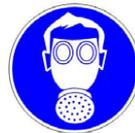
Conformément aux Fiches de Sécurité Produit, le port d'une protection respiratoire, de gants de sécurité et de lunettes de sécurité pendant toute la procédure de remplissage est obligatoire.
