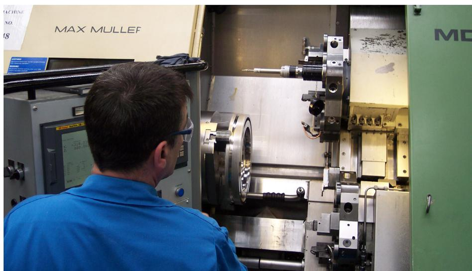
*Palpeur sur tourelle et bras de réglage d'outil amovible sur une machine installée en rétrofit avec une commande Fanuc, uniquement pour s'intégrer aux systèmes de palpage*
