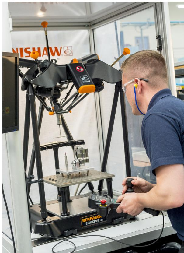
Système Equator utilisé pour inspecter une pièce aéronautique programmée
