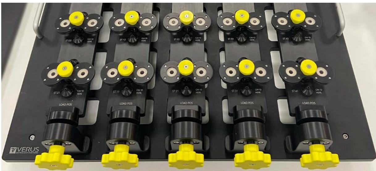
Un bridage sur mesure Verus à 48 postes pour mesurer des composants en caoutchouc souple
