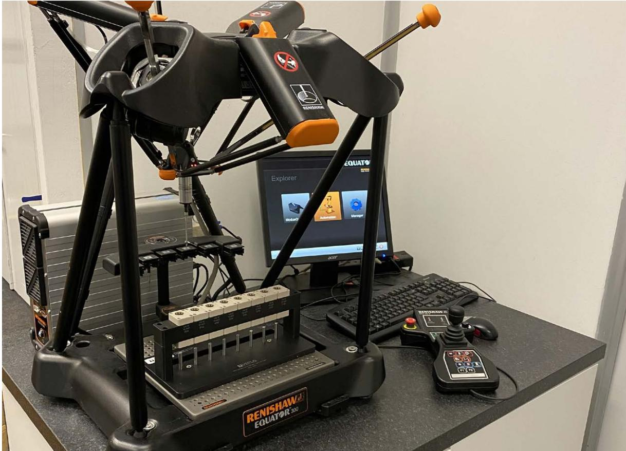
L'une des conceptions de bridage de Verus Metrology contenant des tubes et des bouchons pour inspection sur le système de comparateur Equator™ 300
